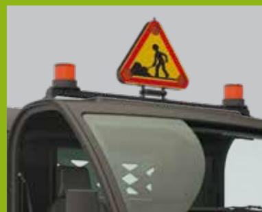
Dachrampe + AK5 Dreieck
